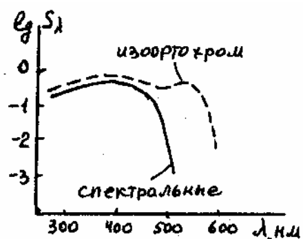
Рис. 14. Кривые спектральной чувствительности фотопластинок "спектральные" и "изоортохром".
